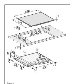
2) Netzanschlusskasten mit Netzanschlussleitung,
